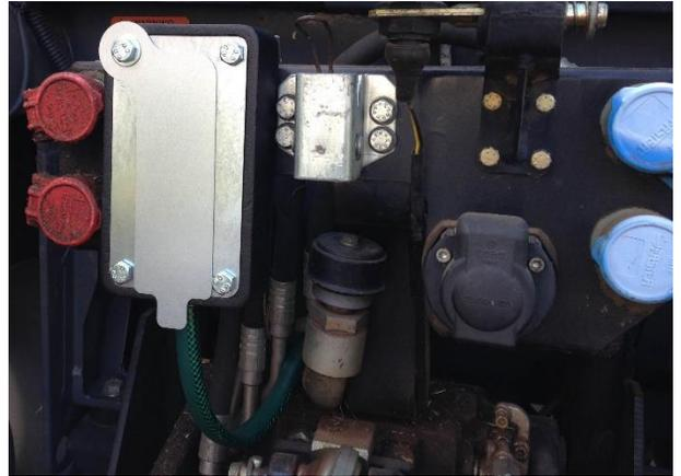
HighEnt 3000 mit geschlossener Staubschutzklappe
